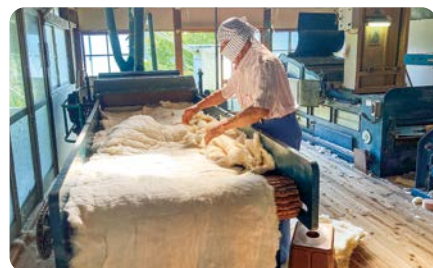
布団綿の打ち直し。ほこりやダニの死骸が集塵機で取り除かれ、綿はシート状に取り出される
